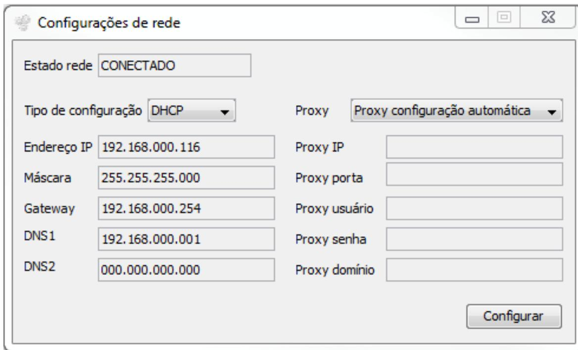
Em “Tipo de configuração” há duas opções, permitir que o equipamento se configure com DHCP ou configurar manualmente a rede escolhendo a opção IP fixo.
