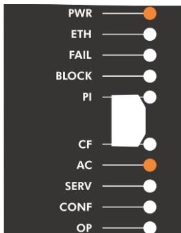
Se o led AC estiver apagado, significa que nenhum comando está sendo executado no Aplicativo Comercial.
