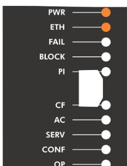
Se o led ETH estiver aceso significa que o cabo de rede está conectado. Se o led estiver apagado significa que o cabo de rede não está conectado corretamente.
