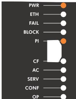
Ao utilizar o equipamento pela primeira vez, ou seja, antes de realizar a ativação com os dados do contribuinte, o led PI estará apagado. Ao concluir o processo de ativação do equipamento, o led permanecerá aceso.
