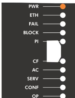
Quando o led PWR estiver aceso, significa que o cabo está conectado e o equipamento está ligado. Caso o led esteja apagado, significa que o cabo USB não está conectado corretamente.
