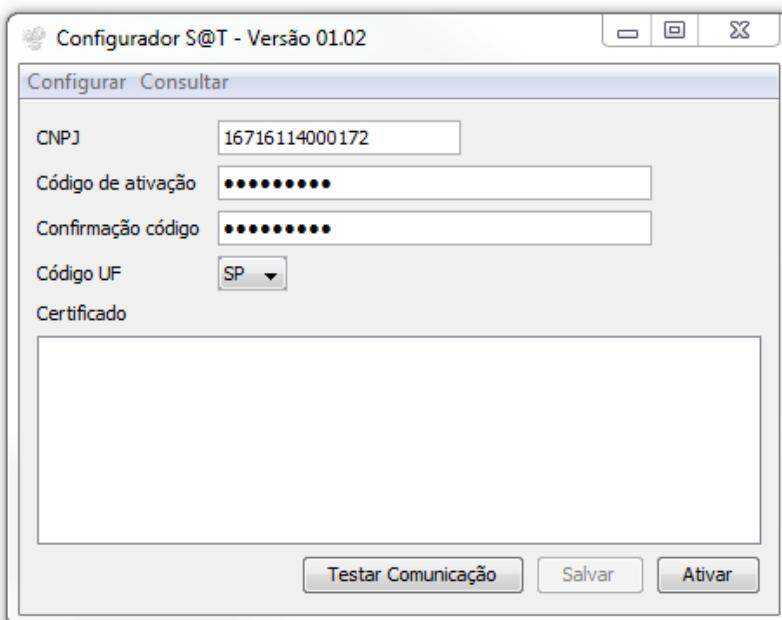
Para testar se a conexão física do computador com o SAT está correta, clique no botão “Testar comunicação”. Caso o computador esteja conseguindo se comunicar com o SAT, uma mensagem de sucesso aparecerá. Caso contrário, será necessário verificar se o driver está instalado corretamente e/ou verificar se o LED OP está aceso. Caso não esteja, aguarde um instante até que o LED acenda.
