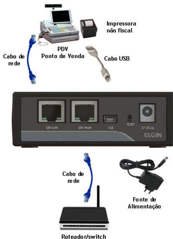
Figura 6 - SAT instalado fisicamente com todos os cabos
