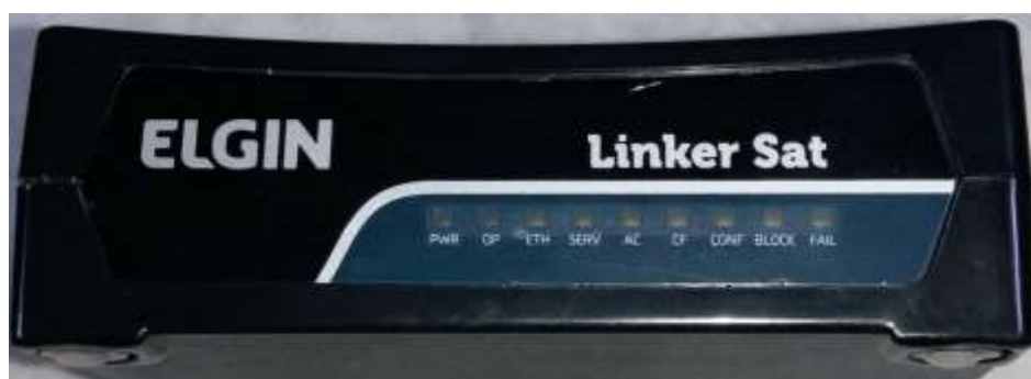
Figura 1 – Vista frontal dos indicadores luminosos de sinalização
