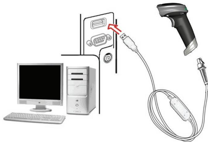
Primeiro encaixe o cabo do leitor e depois na porta USB do computador. Aguarde em torno de 5 segundos até o leitor ficar pronto para uso.
