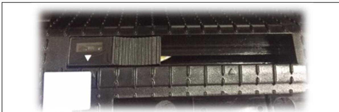
Com o sensor de etiquetas **totalmente** encostado no **lado esquerdo** (padrão de fábrica), a configuração no software L42Pro Utility deve ser:
